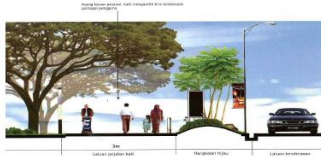
Rajah 5.3 : Keratan rentas menunjukkan laluan sikal dan jalan raya yang diasingkan oleh bahu jalan
